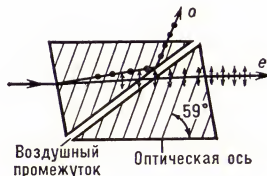
Рис. 2. Укороченная поляризационная призма Фуко с воздушным промежуток. Обозначения те же, что и на рис. 1.
